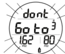
Fig. 120 - GAS SWITCH WARNING
