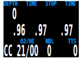
Чтобы решить показания, каких датчиков будут достоверны, используется алгоритм голосования. Если разброс показаний датчиков относительно друг друга не превышает  $\pm 20\%$ , такие показания считаются достоверными.
