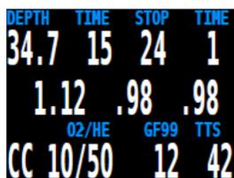
Во-вторых, GF в начале декомпрессии строит линейную функцию от самой глубокой остановки до поверхности. Градиент, используемый для генерации остановок, основан на этой линейной функции.
