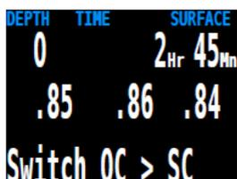
Компьютер, с режимом внешнего мониторинга кислородных датчиков, имеет возможность расчета декомпрессии для полузакрытого цикла (SC). Для включения этого режима воспользуйтесь "System Setup+" меню.
