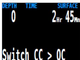
Функция "Switch to OC/CC" выполняет переключения между открытым и закрытым циклами. В зависимости от текущего режима компьютера, на его экране будет отображаться или "Switch CC > OC" или "Switch OC > CC".
