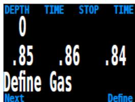
Эта функция позволяет установить 5 газов для закрытого цикла и 5 газов для открытого цикла. Для редактирования газов закрытого цикла компьютер должен быть в режиме закрытого цикла, и для редактирования газов открытого цикла компьютер соответственно должен находиться в режиме открытого цикла.
