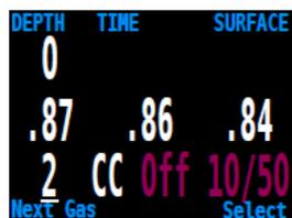
Функция "Select Gas" (выбор газа) позволяет выбрать газ из списка заранее введенных газов. Выбранный газ будет использоваться либо в качестве дыхательного газа в открытом цикле, или в качестве дилуэнта в закрытом цикле.
