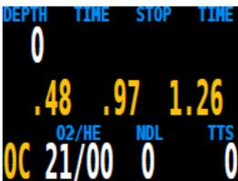
В этом режиме показания внешних датчиков кислорода по прежнему будут отображаться на главном экране. Однако системное  $ppO_2$ , используемое для расчета декомпрессии, будет переключено на открытый цикл (т.е. величина  $ppO_2$  будет равна процентному содержанию  $O_2$  в газе умноженному на давление текущей глубины).
