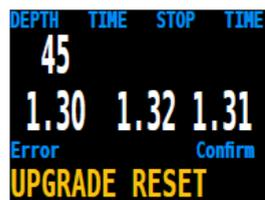
Ошибка **"UPGRADE RESET"** появляется после обновления прошивки. Это штатное событие, которое показывает, что компьютер был перезагружен после обновления прошивки.
