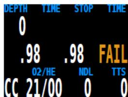
Для изменения содержания кислорода в калибровочном газе ( $FO_2$ ) используйте меню: System Setup+  $\Rightarrow$  O2 Setup.
