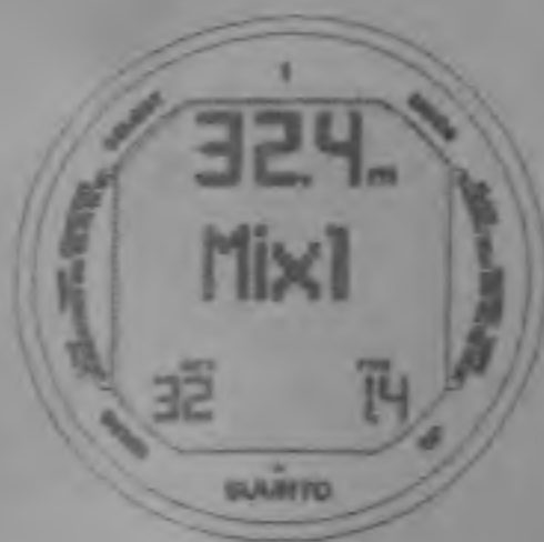
Рис. 5.13. Установка 1 ДГС (MIX1). Содержание кислорода 32%, предел парциального давления 1.4 бар. Максимальная глубина погружения 32.4 м. Нажмите кнопки прокрутки, чтобы изменить содержание кислорода и установить парциальное давление. Чтобы подтвердить установки, нажмите на S.
