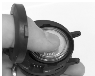
уплотнительное кольцо крышки батарейного отсека
