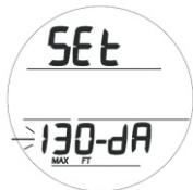
Рис. 47 Установка глубинного сигнала
