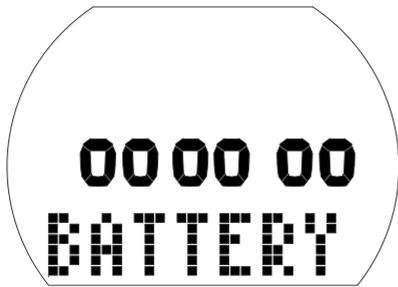
Статус батарейки доступен в этом меню. Полностью заряженной батарейке соответствует индикация шести нулей, с убыванием количества нулей в ходе разряда батарейки.
