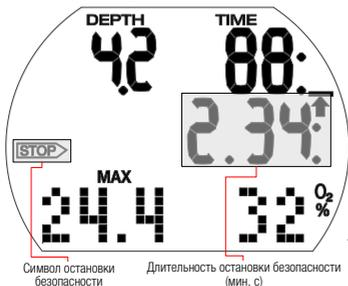
Таймер остановки безопасности отсчитывает время, которое дайверу надлежит провести на этой глубине перед завершением погружения. Таймер включается автоматически как только при всплытии достигается глубина 5 м (15 фт) и производит обратный отсчёт 3 минут. Таймер можно перезапускать неограниченное количество раз. Таймер можно выставить на отсчёт периодов от 1 до 5 минут.
