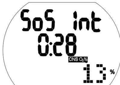
Режим SOS (блокировка компьютера на 24 ч) и поверхностный интервал после погружения
