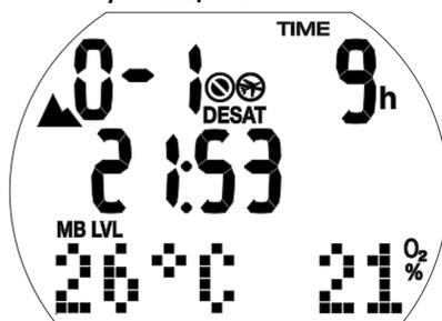
Долгое нажатие правой кнопки в экране текущего времени вызывает остаток времени насыщения\*. Время насыщения определяется с учётом накопленной дозы кислородного отравления, азотной насыщенности тканей или растворением микропузырьков (МП) и истекает с исчезновением последнего из перечисленных факторов.
