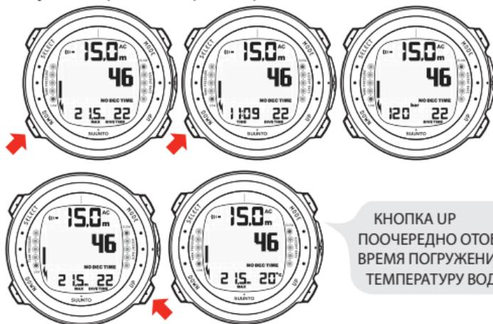
КНОПКА DOWN ПООЧЕРЕДНО ОТОБРАЖАЕТ ЗНАЧЕНИЕ МАКСИМАЛЬНОЙ ГЛУБИНЫ, ТЕКУЩЕГО ВРЕМЕНИ И ДАВЛЕНИЯ В БАЛЛОНЕ.
