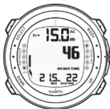
ДИСПЛЕЙ ПОГРУЖЕНИЯ - ТЕКУЩАЯ ГЛУБИНА 15 М, БЕЗДЕКОМПРЕССИОННЫЙ ПРЕДЕЛ ВРЕМЕНИ 46 МИН. МАКСИМАЛЬНАЯ ГЛУБИНА ПОГРУЖЕНИЯ СОСТАВЛЯЛА 21,5 М, С НАЧАЛА ПОГРУЖЕНИЯ ПРОШЛО 22 МИН.
