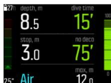
Для каждого представления режима можно задать отображение конкретных данных в настраиваемых полях. При изменении представления в DM5 возможен предварительный просмотр того, как он будет выглядеть в Suunto EON Steel.
