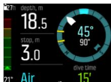
Под направлением движения (крупное число в центре компаса) также отображается относительная разница между азимутом и направлением. Например, если нужно двигаться точно по азимуту, нижнее число должно быть 0°.
