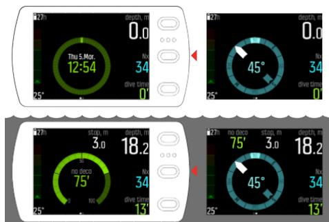
В нижнем правом поле отображаются несколько параметров, включая максимальную глубину, давление в баллонах, таймер, а во время погружения также время без декомпрессии и остановки. Чтобы изменить отображение, нажмите нижнюю кнопку.
