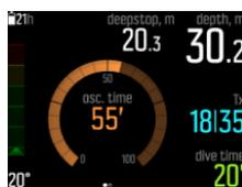
Suunto EON Steel всегда показывает значение потолка, взятое для наиболее глубокой из этих остановок. Когда вы выполняете остановку, потолки остановки на глубине и остановки безопасности всегда находятся на постоянной глубине. Обратный отсчет времени остановки производится в минутах и секундах.
