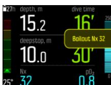
В случае исправления неполадки или иной нормализации погружения можно снова переключиться на разжижитель с помощью указанной ниже аналогичной процедуры, однако теперь разжижитель нужно выбрать в пункте **CC gases** (Газы замкнутого цикла).
