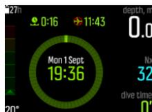
Бесполетный интервал всегда составляет не менее 12 часов и равняется интервалу десатурации, когда его длительность превышает 12 часов. Если интервал десатурации короче 70 минут, бесполетное время не отображается.
