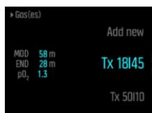
При погружении с использованием только одной газовой смеси, проверьте, что в меню **Gas(es)** (Газовые смеси) только один газ. В противном случае, Suunto EON Steel предполагает, что вы используете все газовые смеси в списке и уведомляет о необходимости изменения газа при погружении.
