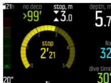
Остановки на глубине активируются, если вы погружаетесь глубже 20 м (65,6 фт.). Остановки на глубине отображаются аналогично остановкам безопасности. Вы находитесь в зоне остановки на глубине, когда перед указателем глубины остановки отображаются стрелки вверх или вниз и начинается обратный отсчет времени остановки на глубине.
