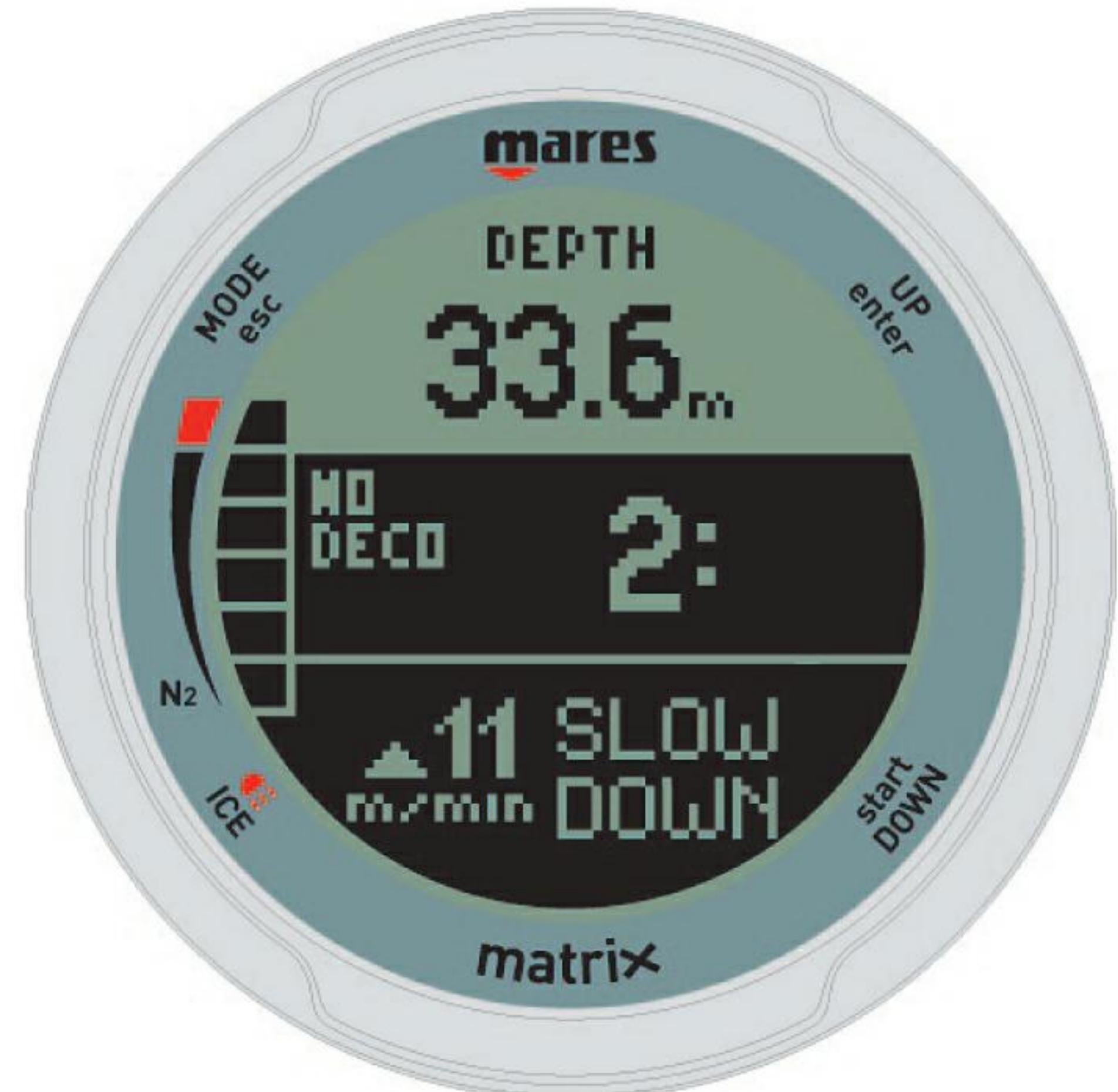
Если скорость всплытия превышает 12 м/мин (40 ft/min) на глубине более 12 м, то высвечивается предупреждение TOO FAST. Если скорость будет такой и выше на протяжении 2/3 пути, Matrix заблокируется на сутки.
