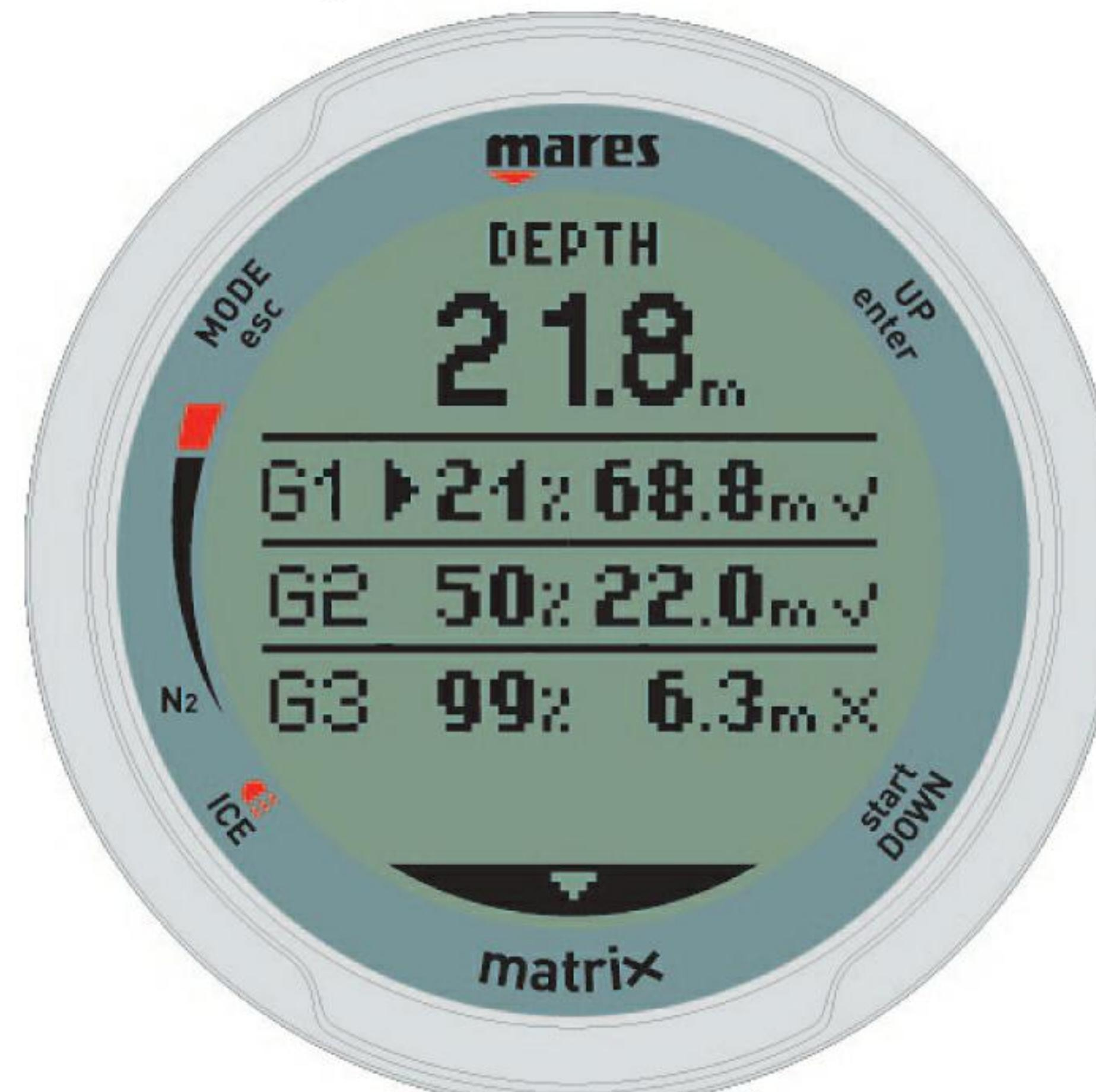
Matrix всегда начинает погружение с G1, который меньше всего насыщен кислородом. Если вы достигаете глубины, где надо переключиться на G2, Matrix подает соответствующий сигнал и значек GAS 1 -> GAS 2 внизу экрана.
