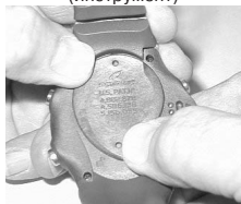
Рис. 112В - АЛЬТЕРНАТИВНОЕ СНЯТИЕ КРЫШКИ
